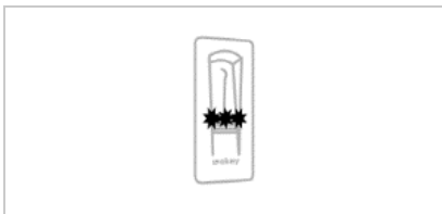
Rys. 4: Sygnalizacja optyczna czytnika linii papilarnych
