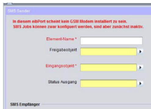
Abbildung 133: Job Maske – GSM Modem nicht eingebaut / erkannt
