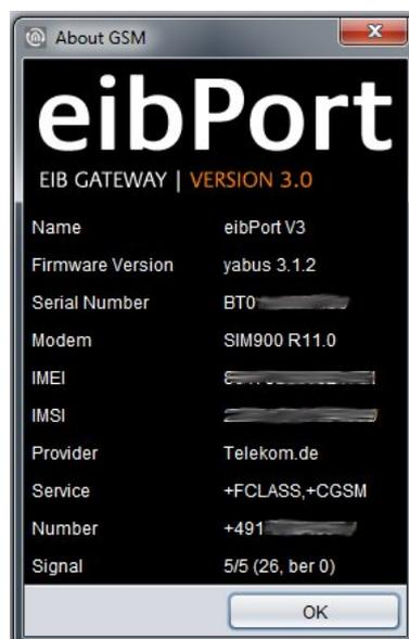
Abbildung 132: Editor – GSM Info Dialog: GSM Modem eingebaut
